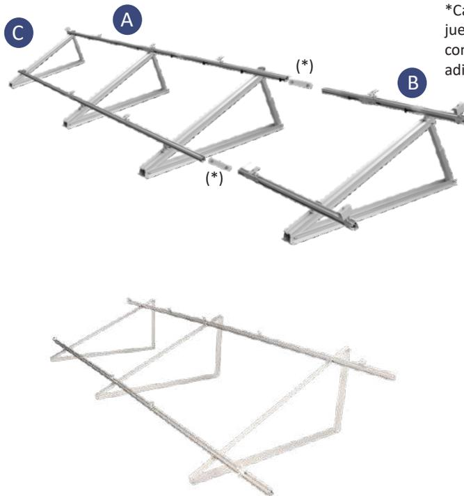
\*Cada estructura adicional incluye un juego de juntas riel para la interconexión con la estructura (A) u otra estructura adicional.
