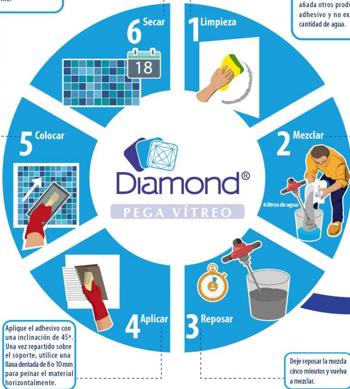
Aplique el adhesivo con una inclinación de 45°. Una vez repartido sobre el soporte, utilice una llana dentada de 8 o 10 mm para peinar el material horizontalmente.
