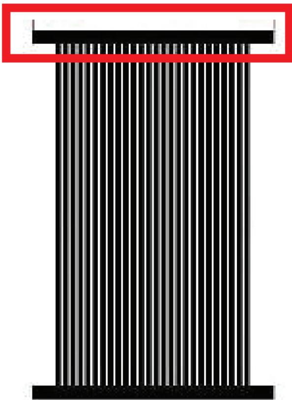
El proceso de fijación entre la tubería de alimentación y la tubería de transferencia se realiza a través de la inyección del Polipropileno de forma continua, sobre las superficies ya colocadas de ambas tuberías, proceso llamado internamente de sobremoldeado este proceso unifica las piezas haciendo que se convierten en un único producto
